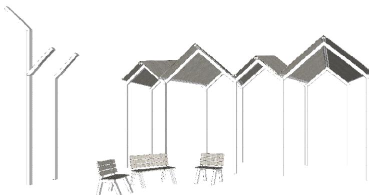
Las pérgolas se configuran mediante una estructura de acero y una cubierta a dos aguas, inspirándose en su concepción formal las cubiertas del entorno. Un gesto evocador que pretende dar unidad a la intervención, integrándose de forma amable dentro de la escena urbana.
